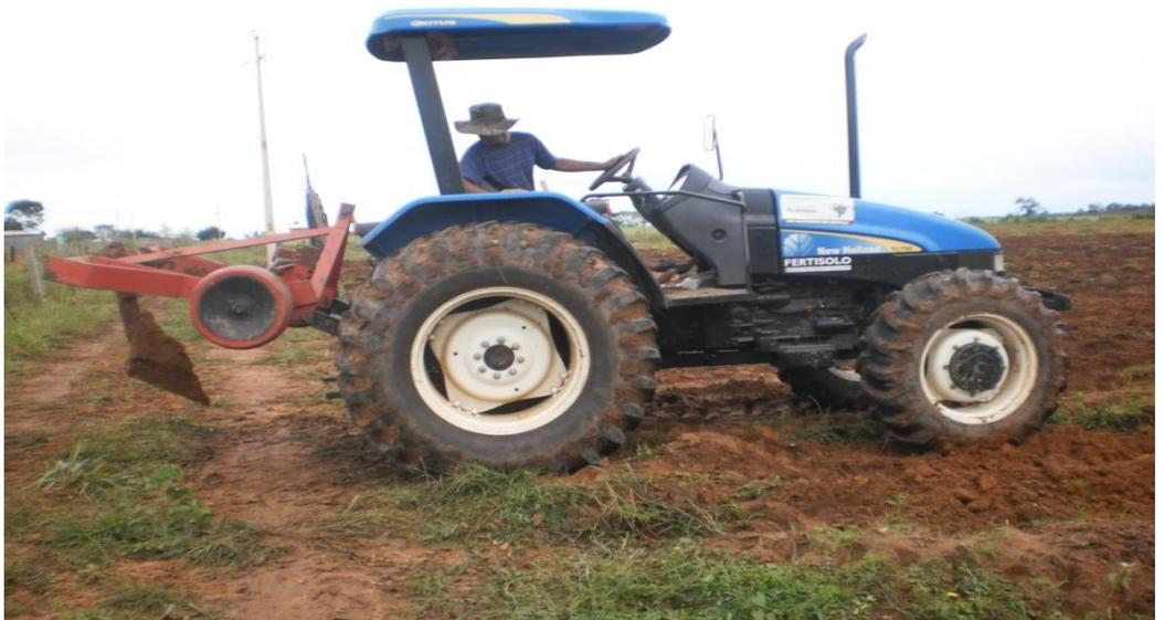
Figura 23 - Trator equipado com Bico de Pato
