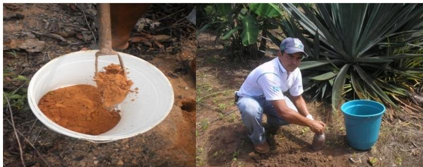
4 – Coloca-se as amostras em um balde de plástico limpo; após coletados todos os pontos, homogeneizar as amostras fazendo um composto com aproximadamente 500 g., identificar e enviar ao laboratório para análise.
