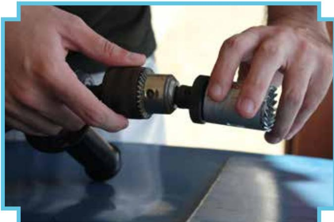
1 - Coloque a ponta serra-copo de 25 mm
